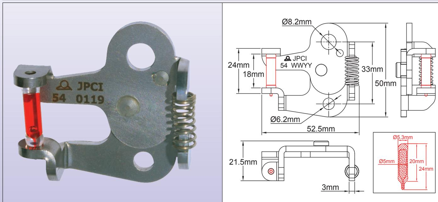
Réalisés en acier zingué de 3mm d'épaisseur, ces mécanismes démultiplicateurs sont compatibles avec les bulbes thermo-frangibles de 5 x 20mm. En raison de leur important coefficient de démultiplication, la force appliquée sur le bulbe en verre est seulement 15% de celle appliquée sur le mécanisme. Le remplacement des bulbes est simple et peut se faire sans outillage spécial.
