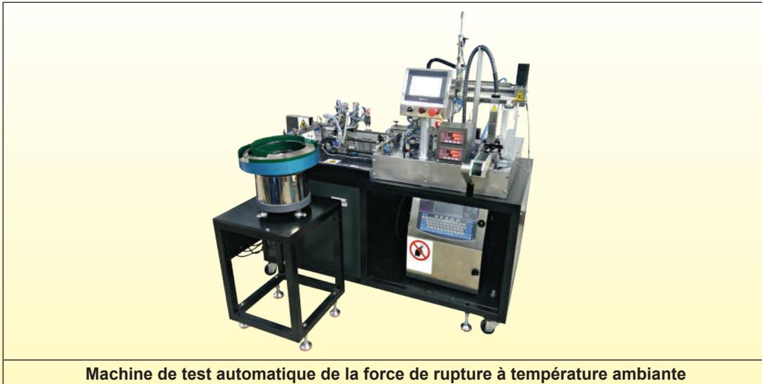
Machine de test automatique de la force de rupture à température ambiante
