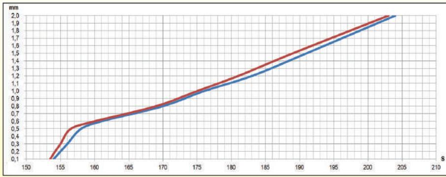
Temps de réponse **moyen** et température moyenne de déclenchement mesurés sur toute la gamme des maillons fusibles, soudés avec l'alliage eutectique non Rohs à 72°C
