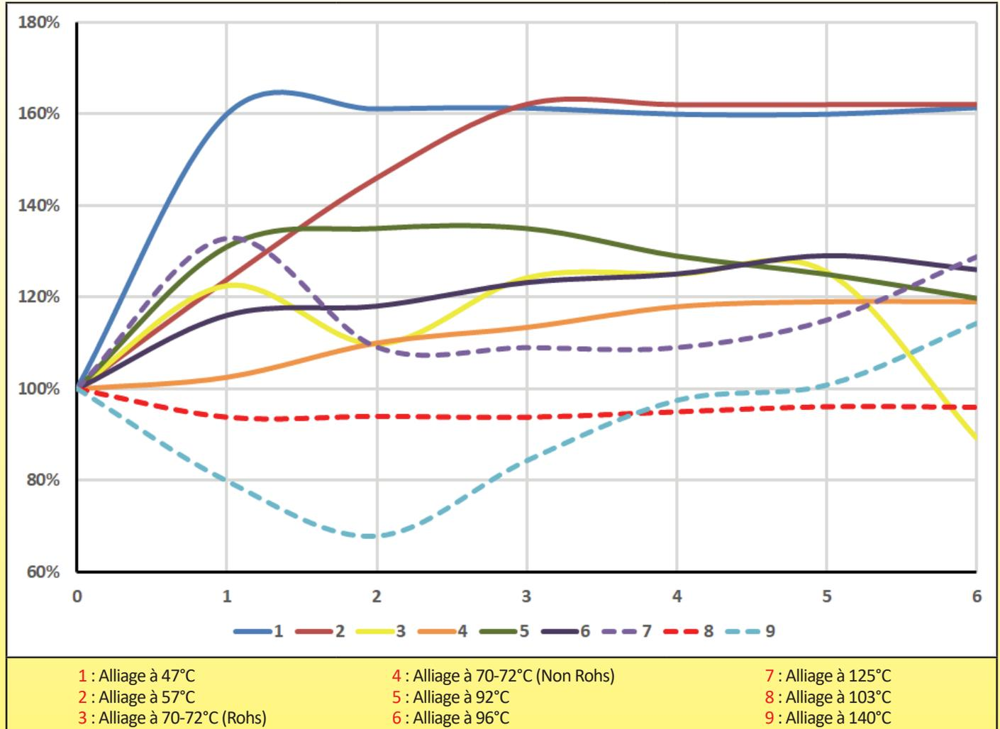
Les courbes ci-dessus représentent la variation de la résistance dans le temps, en % de la valeur mesurée immédiatement après soudure, pendant 6 semaines d'éprouvettes soudées, utilisant une soudure de 225mm<sup>2</sup> de surface, réalisée avec différents alliages. Valeurs mesurées dans notre propre équipement de test à une vitesse de traction lente de 0.05mm/min.
