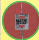
Positionnement des déclencheurs fusibles ou à ampoule dans la veine d'air pour la mesure de la température de déclenchement
