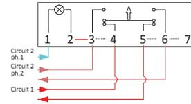
Raccordement de plusieurs boîtiers, en série pour les contacts à ouverture lors du déclenchement (circuit 1) et en parallèle pour les contacts à fermeture (circuit 2), avec lampe témoin de présence de tension sur le circuit 2. Les deux circuits peuvent être de tensions différentes.
